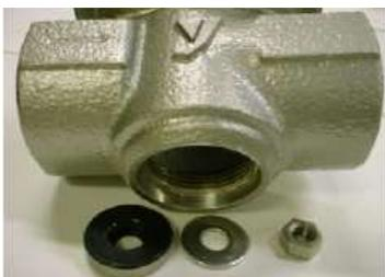
9-1)平座金、ダイヤフラム押え、ダイヤフラムの順に取外します。
