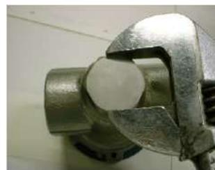
21) 圧力調整後、六角袋ナットを調節ねじの
