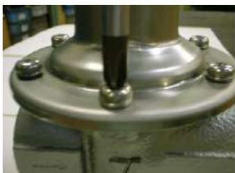
4)ばねカバー,調節ばね,調節ねじを取外します。
