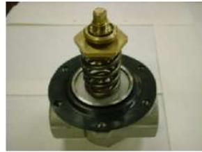
18)ばね座金、十字穴付なべ小ねじをばねカバーへ入れて、全部の小ねじを+ドライバーにて軽く締め、その後、対角線上に本締めしてください。
