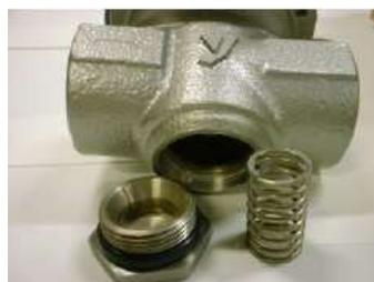
8)ダイアフラム上部の U ナットと弁体側の六角ナットを同時に呼び 10 のソケットレンチを掛け、弁体側のナットを外します。次に平座金、弁体 P の順に取外します。〈このとき、ダイアフラム側のナットが緩んだ場合は U ナットを先に取外します。手順は(9-1)へ移ってください。〉
