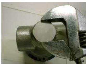
7)弁体ばねを取外します。
