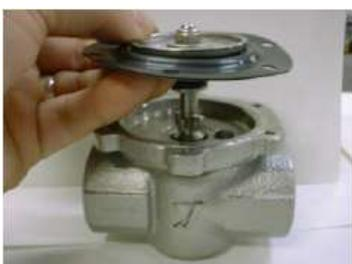
9-2)次に弁棒の六角部に工具を掛け弁体 P 側の六角ナットを外します。
