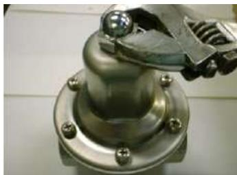
2)二面の調節ねじを左回転で緩め、ばね荷重を無荷重にします。
