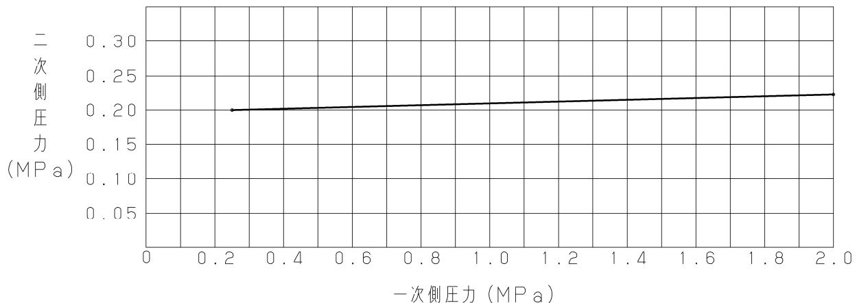
一次側圧力 0.25MPa の時、二次側圧力を 0.20MPa に圧力設定をし、一次側圧力を 2.0MPa まで変化させた時の二次側圧力の変動を示す。
