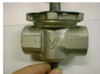
9)弁体 P、平座金、六角ナットを取外します。
