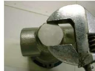
21)圧力調整後、六角袋ナットを調節ねじのねじ部へ取付けます。
