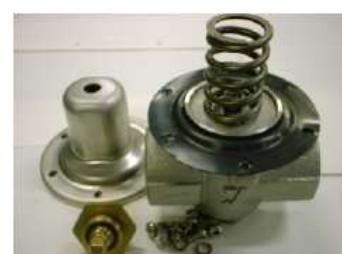
5)ダイヤフラムが破損していないことを確認してください。
