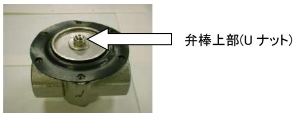
弁棒が動かない場合は I.i 項の手順 6)～10)を行い、弁棒用Oリングを新品に交換してください。交換後は I.i 項の手順 12)～21)を行ってください。
