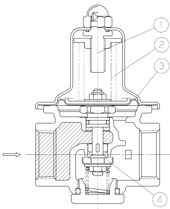
調節ねじ①をねじこむと調節ばね②を圧縮し、ダイヤフラム③を押し下げ、それに直結された弁体P④を開けます。一次側より入った流体は弁体P④上部より二次側へ流出すると同時に二次側圧力として直接ダイヤフラム③に働きます。二次側の止弁が閉止状態の時、ダイヤフラム③にかかる圧力が増し、調節ばね②の荷重に打ち勝ち弁体P④は閉弁します。
