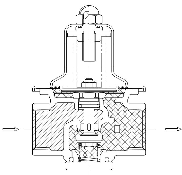
二次側の止弁を徐々に開くとダイヤフラム③に加わっていた圧力が下がり、弁体P④を開弁します。二次側に流出した流体は二次側圧力としてダイヤフラム③に働き、調節ばね②の荷重とバランスをとり、弁開度を調節し二次側圧力を一定に保ちます。
