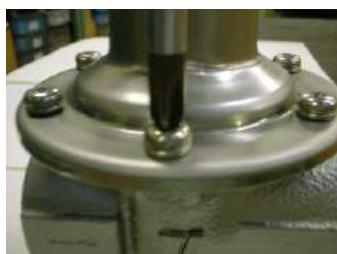
4)ばねカバー、調節ばね、調節ねじを取り外します。
