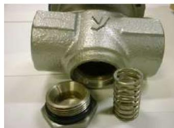
8)ダイヤフラム上部の U ナットと弁体側の六角ナットを同時に呼び 10 のソケットレンチを掛け、弁体側のナットを外します。次に平座金、弁体 P の順に取外します。〈このとき、ダイヤフラム側のナットが緩んだ場合は U ナットを先に取外します。手順は(9-1)へ移ってください。〉
