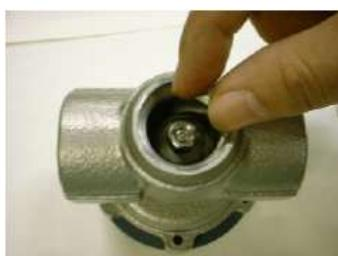
14)ダイヤフラム一式のUナットにソケットレンチ呼び10を掛け、弁体 P 側の六角ナットをトルクレンチでトルク 6N·m(60kgf·cm)で締め付けます。
