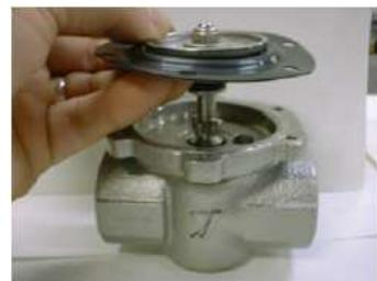
13)弁棒に弁体 P, 平座金を入れ六角ナットを手で締めてください。
