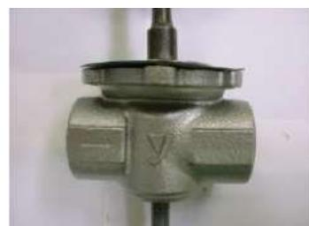
15)ダイヤフラム押えの上に調節ばねを載せます。
