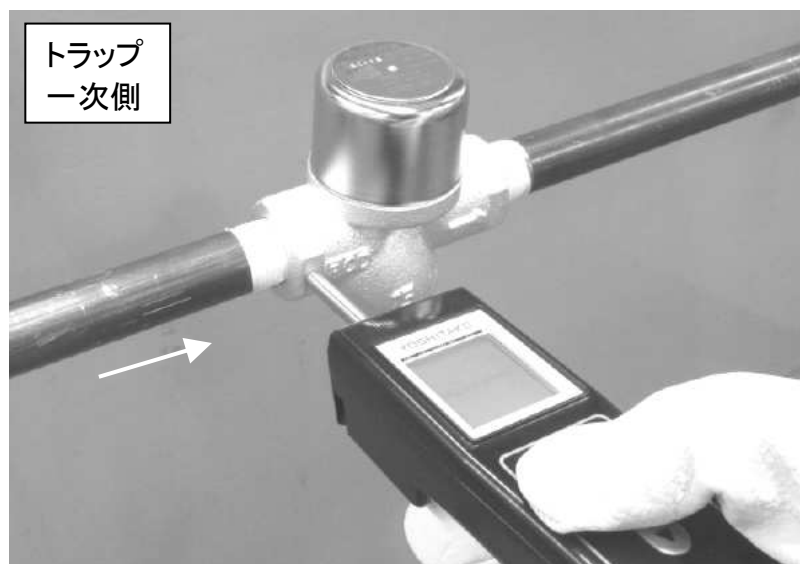
センサ先端部の押し当て例
