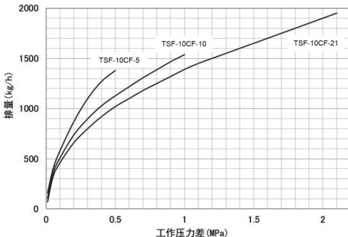
此图显示的是最大连续排放流量。在设计一个系统时，请考虑充分的安全系数 (2倍以上)
