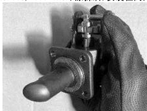
【步骤 2】将阀门一式⑦安装到阀盖②上。
