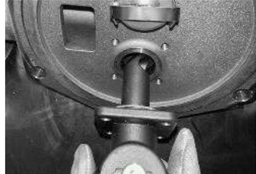
50A: 用扳手（对边宽度 13mm）将六角螺母⑬卸下，然后取下浮球保护板⑩。
